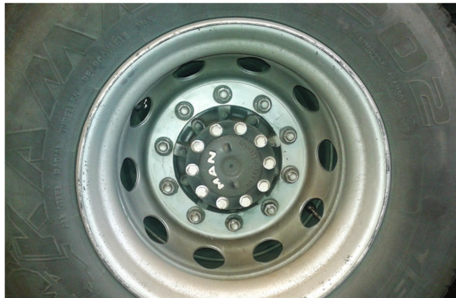
Общий вид сдвоенного колеса с датчиками и тройниками в сборе
