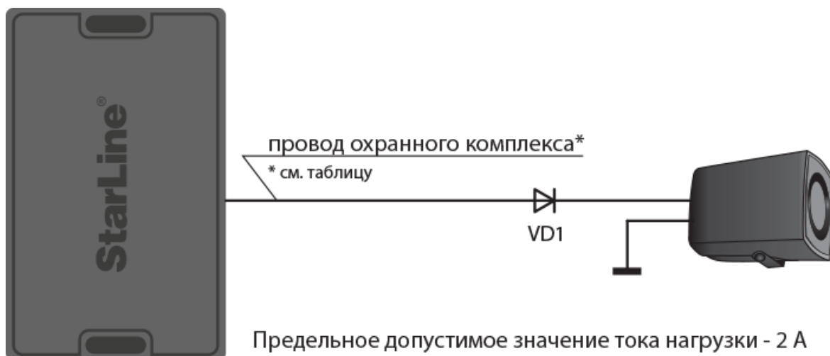
Схема подключения автомобильной сирены
