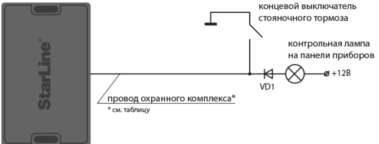
Схема подключения стояночного тормоза
