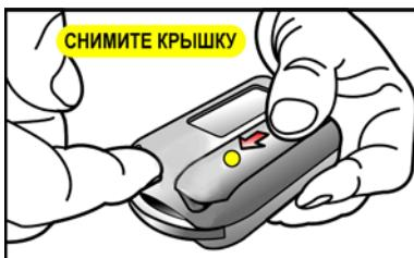
Для замены батареи питания откройте крышку батарейного отсека с обратной стороны пульта, как показано на рисунке – сдвинув крышку в сторону кольца для ключей. Выньте старый элемент, затем вставьте новый, соблюдая полярность подключения. Закройте крышку в обратной последовательности.
