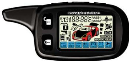
Двусторонний пульт представляет собой миниатюрное приемо-передающее устройство с питанием от 1,5 вольтовой батарейки (типа LR03 AAA), которой, в зависимости от интенсивности использования пульта, хватает на срок от 1 до 6 месяцев. При установке свежей батареи индикатор её заряда
