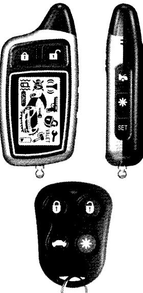
В следующей таблице приведены основные комбинации кнопок брелков. Символ "+" между пиктограммами обозначает одновременное нажатие кнопок, а символ "," – последовательное (с паузами ~0.5-1 сек. между нажатиями). Символ "(x сек.)" обозначает длительное нажатие кнопки.
