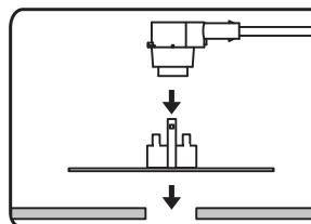
5. приклейте крепление датчика с внутренней стороны бампера, предварительно обезжирев поверхность. Вставьте датчик в крепление
