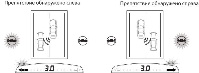
Предупредительный светодиод загорается при обнаружении помехи в слепой зоне, а звуковой сигнал прозвучит при включении поворотников в сторону помехи
