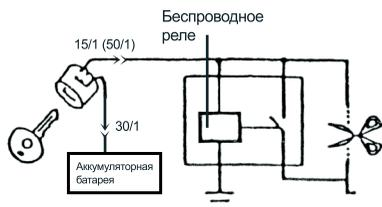
Отключите штатное реле и подключите беспроводное реле
