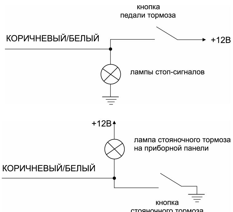
В автомобиле с ручной коробкой передач подсоедините КОРИЧНЕВЫЙ/БЕЛЫЙ провод системы к проводу, замыкающемуся на "массу" при взведении ручного тормоза.
