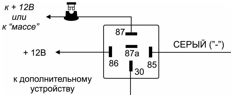
**Подсоединение:** Подсоедините СЕРЫЙ провод к клемме № 85 дополнительного 30A реле, подсоедините клемму № 86 реле к +12V. Подсоедините остальные контакты реле в соответствии с выбранной функцией канала 3 системы.
