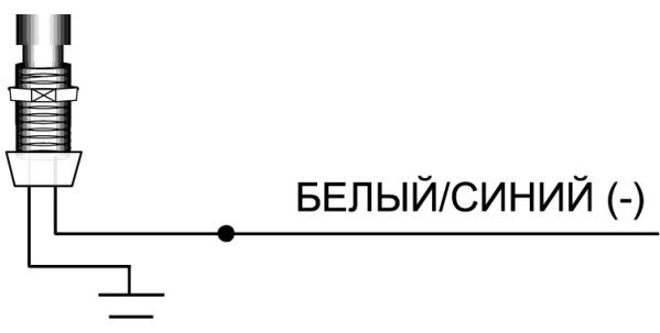
Кратковременная подача сигнала отрицательной полярности на данный вход системы аналогичен 2-кратному нажатию кнопки передатчика в течение 3 секунд и будет вызывать запуск или глушение двигателя.
