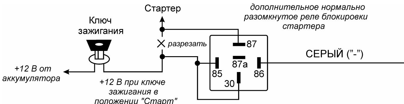
**Примечание:** Обратите внимание на то, что при использовании такого варианта подсоединения питание на реле блокировки будет подаваться только в момент попытки завести двигатель, таким образом, реле блокировки будет потреблять энергию аккумулятора только в момент попытки запуска двигателя.
