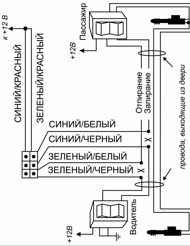
**Схема 4. Вакуумная система (Мерседес-Бенц и Ауди)**
