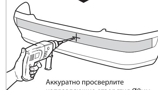
Аккуратно просверлите направляющие отверстия Ø8мм, не забывая про возможные препятствия за бампером. Затем демонтируйте бампер.
