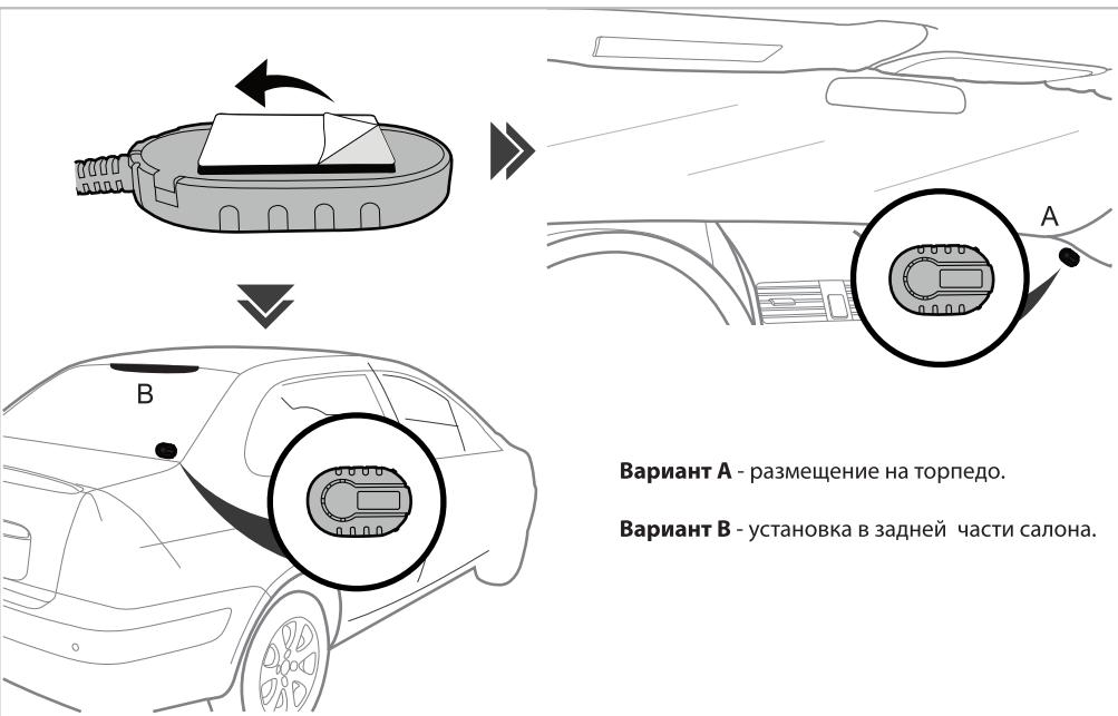
**Вариант А** - размещение на торпедо.
