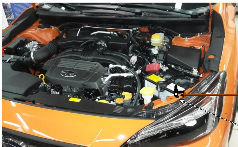
Рис. 12. Установка и подключение дополнительного датчика капота.
