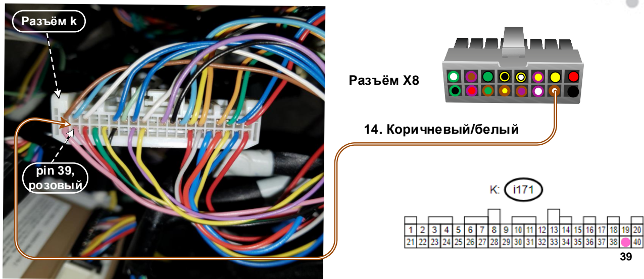
Рис. 20. Подключение имитации открытия двери.
