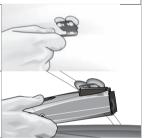
5. При необходимости изменения угла осторожно нажмите на кронштейн или потяните кронштейн на себя, согнув или разогнув его. ЗАПРЕШАЕТСЯ прилагать усилие к детектору для наклона кронштейна.
