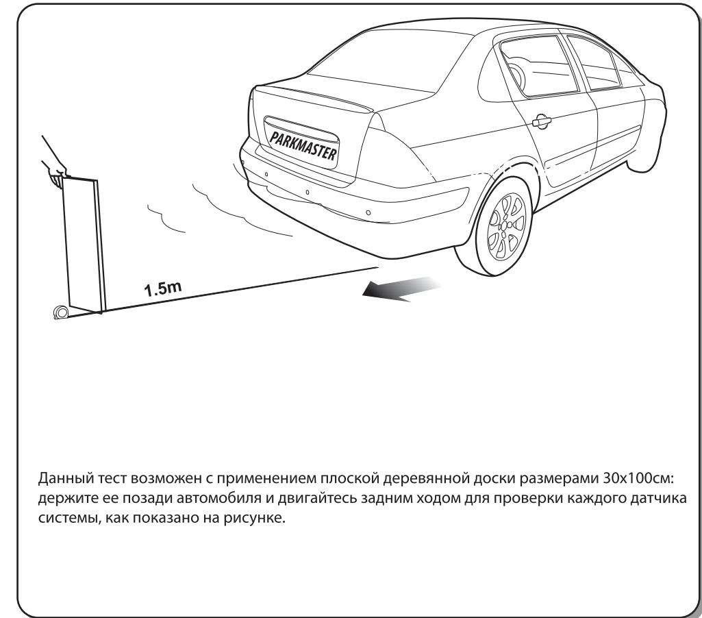
Данный тест возможен с применением плоской деревянной доски размерами 30x100см: держите ее позади автомобиля и двигайтесь задним ходом для проверки каждого датчика системы, как показано на рисунке.
