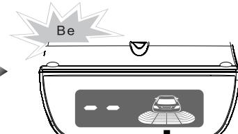
Включите зажигание, переместите ручку коробки передач из позиции N в позицию R 10 раз с интервалом в 1 сек. На 10-ый раз останьтесь в позиции R на 6 сек. Это активизирует функцию запоминания и система больше не будет реагировать на выносные элементы автомобиля.
