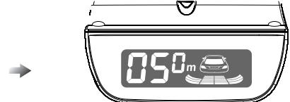
После программирования система будет определять препятствия, игнорируя выносные элементы автомобиля.
