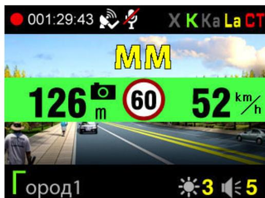
SHO-ME Combo№3 сравнивает скорость автомобиля с разрешенной на участке скоростью. И если скорость автомобиля выше, голосовое оповещение сообщает об этом, а на дисплее зеленая полоса становится красной.
