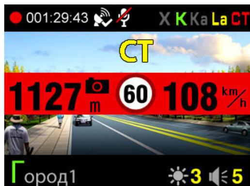
Особый тип камер – контроль средней скорости (КСС), к ним относится система Автодория. Эта система измеряет среднюю скорость движения автомобиля между двумя точками с установленными камерами. Так что для правильного оповещения пользователя Combo№3 считает среднюю скорость после проезда первого модуля КСС и сравнивает ее с лимитом на участке
