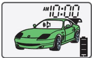
При сильных ударах по кузову: 30 секунд мигают световые сигналы, звучит сирена. Пульт управления подаст звуковой (или вибрационный) сигнал, и на ЖК-дисплее появится изображение
