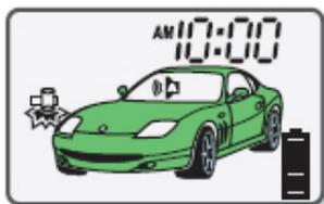
При срабатывании предупредительной зоны датчика удара или внешней зоны до-полнительного датчика, раздадутся 5 коротких звуковых сигналов сирены. Пульт управления подаст звуковой (или вибрационный) сигнал, и на ЖК-дисплее появится изображение
