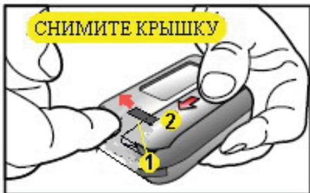
Для замены батареи питания откройте крышку батарейного отсека с обратной стороны пульта, как показано на рисунке – сначала сдвинув замок, а затем сдвинув крышку в сторону кольца для ключей. Выньте старый элемент, затем вставьте новый, соблюдая полярность подключения. Закройте крышку в обратной последовательности.
