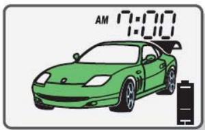
Отпирание багажника возможно и в режиме охраны, если включена функция автоматического выключения режима охраны при дистанционном отпирании багажника (Программируемая функция №10). При этом система одновременно с отпиранием багажника выключит режим охраны и отпирёт двери, а на ЖК-дисплее появится изображение
