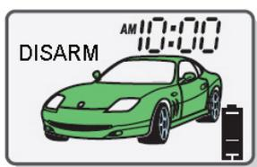
Если в режиме охраны включалась тревога, то при выключении режима охраны прозвучат три звуковых сигнала, фонари вспыхнут 3 раза. После включения зажигания светодиодный индикатор будет давать серии вспышек (см. Таблицу на стр. №4), индицирующие датчик, вызвавший тревогу.
