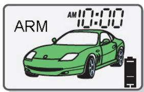
Если при включении охраны не закрыта дверь, капот, багажник, то система сообщит об этом четырьмя дополнительными звуковыми сигналами, а на экране пульта появится изображение:
