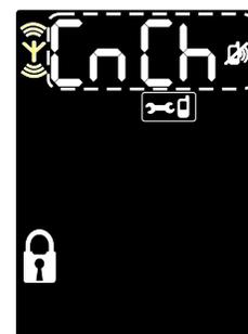
**Включить/выключить звук контроля радиоканала.** При выборе этого пункта мигает надпись **ChCh** (Channel Check) и пиктограмма брелока с отключенным звуком. Для входа в пункт нажмите **OK**. Кнопками **ВПЕРЕД** и **НАЗАД** установите нужное значение
