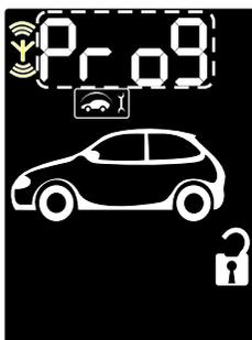
**Вход в режим программирования (Prog)** системы выполняется нажатием кнопки **OK** только из режима **СНЯТ С ОХРАНЫ** при включенном зажигании (двигатель не работает). Собственно программирование системы ГРИФОН выполняется с помощью кодонаборного переключателя. При подаче из режима ОХРАНА команда игнорируется.
