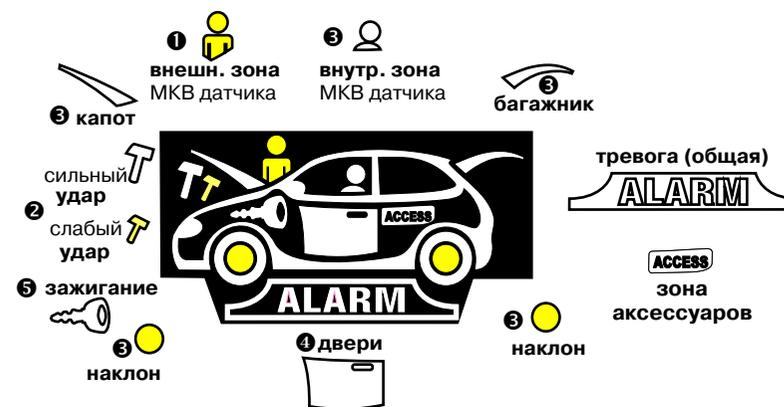
Если при постановке на охрану зона была неисправна, то она исключается из числа охраняемых зон и подается предупреждение - 3 сигнала.
