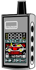
В обычном состоянии на экране видны часы, показывающие текущее время, пиктограмма режима **ОХРАНА** или **СНЯТ С ОХРАНЫ** (закрытый или открытый замок) и другие пиктограммы. Для включения подсветки нажмите кнопку **OK**.
