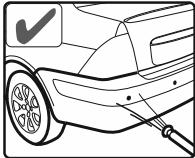
После мойки и/или очистки датчиков, просушите их с помощью сжатого воздуха.
