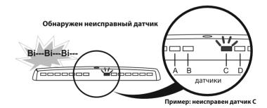
Кратковременно включится красный сектор шкалы приближения, который указывает место расположение неисправного датчика, прозвучит три звуковых сигнала. Далее, система перейдет в рабочий режим с использованием исправных датчиков.
