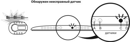
Пример: неисправен датчик С
