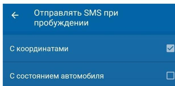
Если установлена одна из настроек "Отправлять SMS при пробуждении", то при каждом пробуждении устройства отправляет SMS с координатами или состоянием, или и тем и другим на телефон M1.
