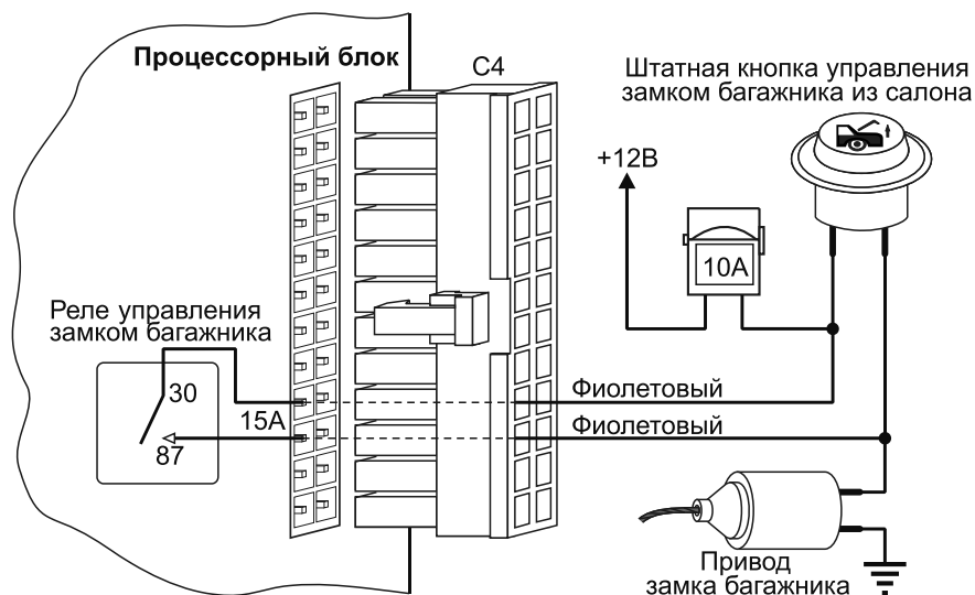
Рис.13. Подключение соленоида отпирания замка багажника – отпирание при подаче МАССЫ.
