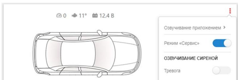
**Локальное включение** режима “Сервис” производится вводом персонального PIN-кода. Выключается режим “Сервис” вручную, вводом персонального PIN-кода “Сервис”, увеличенным на единицу, или автоматически при удалении автомобиля от места включения режима на 1 км и постановке на охрану.
