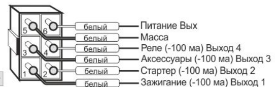
Разъем X6 (Релейный модуль)
