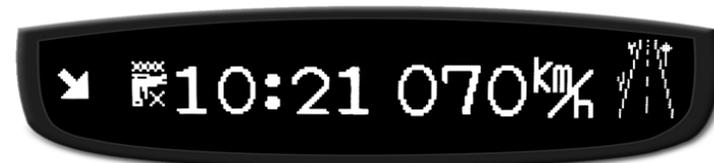
При обнаружении сигнала радара звуковой сигнал в зоне **Тихого режима** не подаётся, на дисплей вместе со скоростью выводится диапазон и уровень сигнала:
