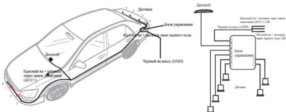
Общая схема подключения парковочных радаров
