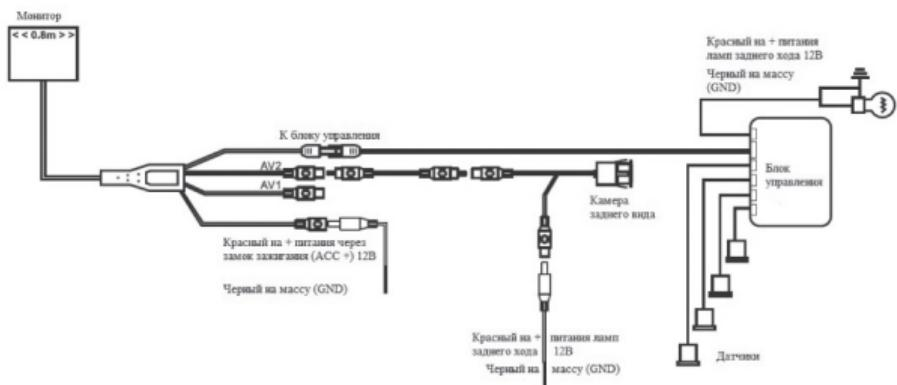
Схема подключения парковочного радара PS-842U
