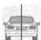
Сильный дождь и снег ухудшают чувствительность датчиков
