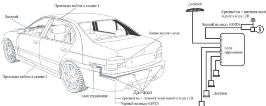
Общая схема подключения парковочных радаров
