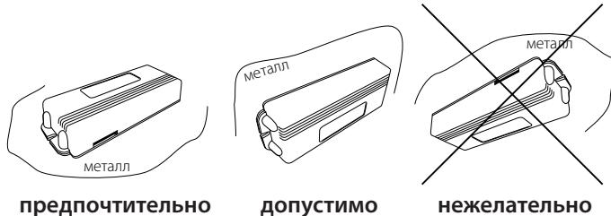
Устанавливать MS-PGSM Спутник рекомендуется в пределах салона автомобиля вдали от нагревающихся или подвижных элементов.
