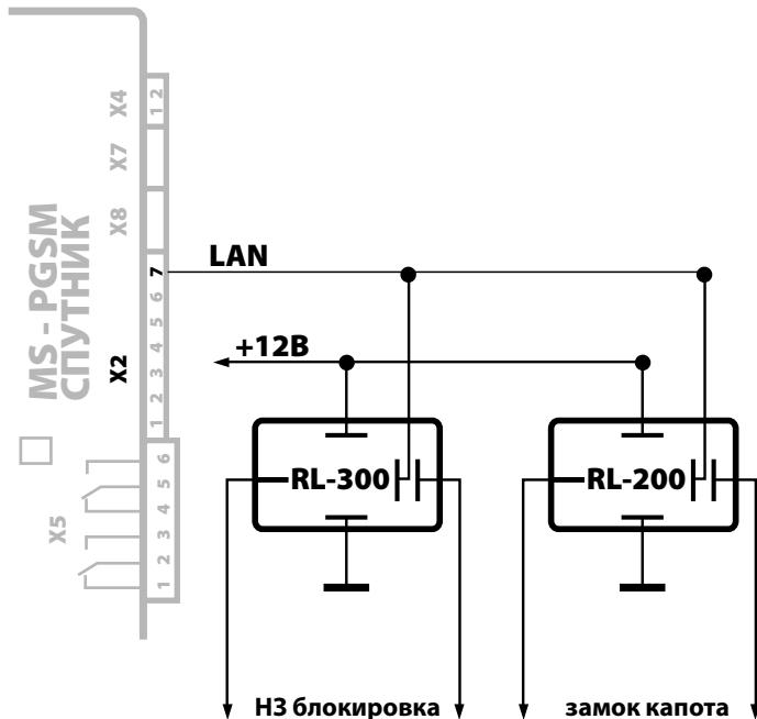
По цифровойшине LAN возможно подключение нескольких реле-иммобилайзеров RL-300.
