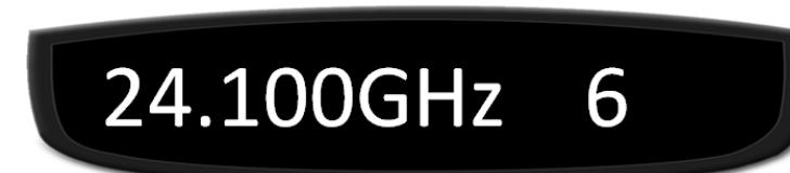
*На рисунке: Информация на дисплее при обнаружении радарного сигнала среднего уровня мощности, работающего в диапазоне K:*
