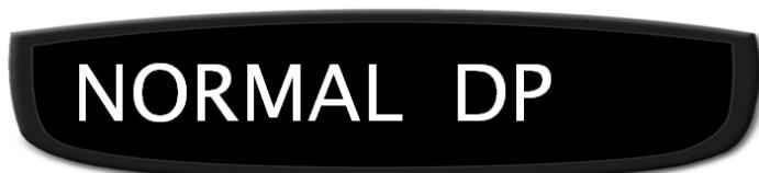
В этом режиме ( заводская установка) при обнаружении сигнала радара на дисплей после названия диапазона будут выведены графический и цифровой индикаторы уровня обнаруженного сигнала.
