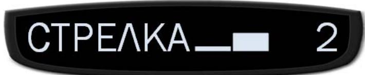
На рисунке: Информация на дисплее при обнаружении очень сильного сигнала радара **Стрелка**:
