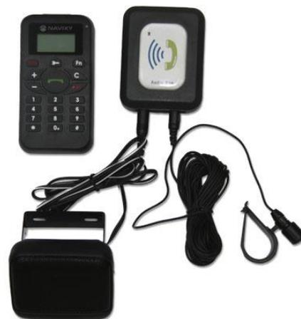
Беспроводная клавиатура имеет цифровые клавиши для набора номера, крупные кнопки ответа и завершения вызова, регулировки громкости. Отдельно стоит отметить наличие кнопки передачи тревожного сигнала «SOS». На алфавитно-цифровом ЖК-дисплее отображается вызываемый номер, состояние устройства, уровень заряда батареек (в клавиатуре используются две батарейки АА). При нажатии клавиш клавиатура подсвечивается изнутри, обеспечивая комфортный набор в сумерки и ночное время.
