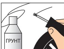
Если повреждение коснулось металла (глубокая царапина/ скол), необходимо сначала нанести **грунт «Avtomark»** для защиты кузова от коррозии. При необходимости грунт наносится в несколько слоёв. Промежуточная сушка каждого слоя занимает от 15 - 20 минут при температуре 20° С.
