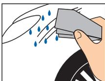
Место повреждения тщательно протереть сухой тканью, чтобы не осталось следов воды. Поставить автомобиль в хорошо освещённое помещение и визуально оценить степень повреждения лакокрасочного покрытия.
