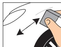
Прижать бумагу пальцами к боковым поверхностям ластика. Работать следует узкой стороной. Начать шлифовать активно – с небольшим нажимом – и строго вдоль повреждения (это очень важно!) поступательными движениями. Необходимо выровнять «горку», сделать её более гладкой, но не сравнять полностью с поверхностью кузова, поскольку имеется риск повреждения соседних участков до уровня грунта.
