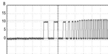
Момент прекращения прокручивания стартера автосигнализация определяет по резкому возрастанию частоты сигнала в момент начала работы двигателя. Подключение серо-черного провода к такой цепи гарантирует правильное отключение стартера. Заведенному двигателю соответствует частота - около 20 Гц или 600 об/мин.
