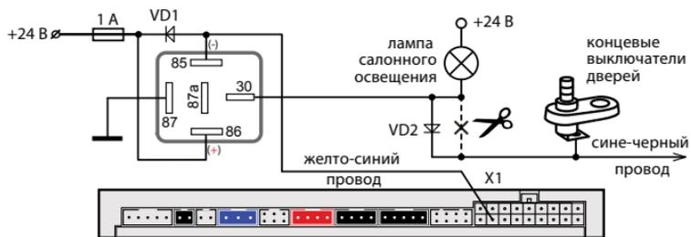
Дополнительный канал 4 также может быть использован для подключения к ближнему свету фар и реализации функции «световая дорожка». См. схему подключения далее:
