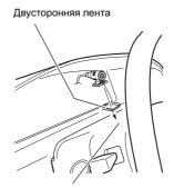
Установите микрофон на рулевой колонке на достаточном расстоянии от рулевого колеса.
