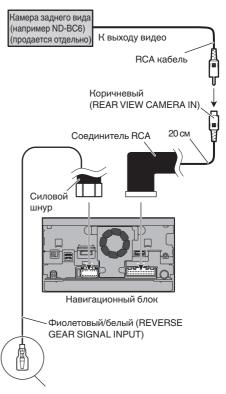
Подробная информация о проводах содержится в Подключение силового шнура (2) на стр. 16.
